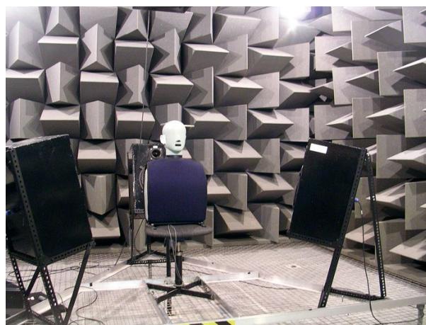
Fig. 8.3 registrazione binaurale con una "dummy head" (testa finta), in una camera anecoica.
