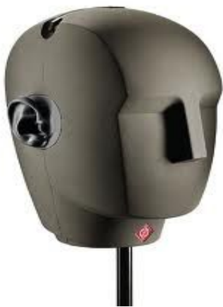
Fig. 8.4- La testa finta usata per le registrazioni binaurali
